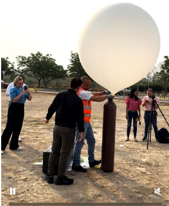
Llenado de Globo de látex con Helio al 95%
