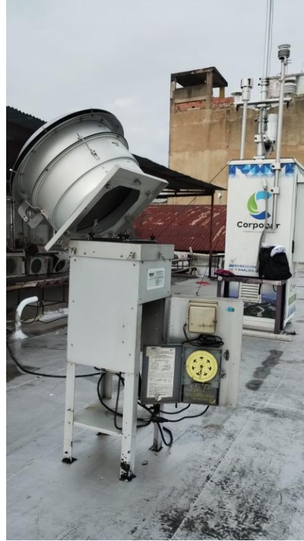
Unidad HI-VOL con cabezote abierto
